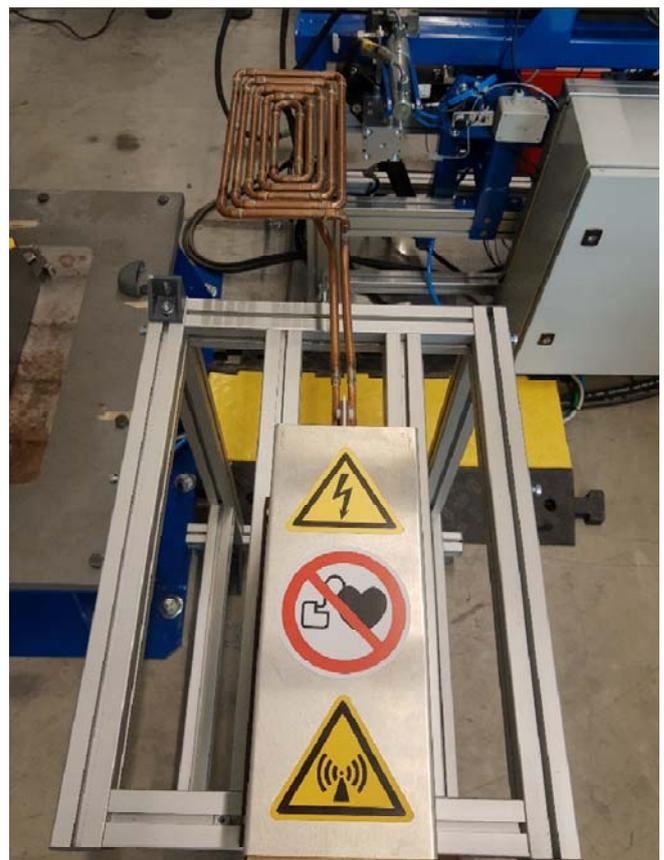
Abbildung 9: Induktionsmodul
