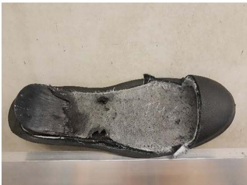
Abbildung 7: Getrennte Laufsohle nach induktivem Erhitzen
