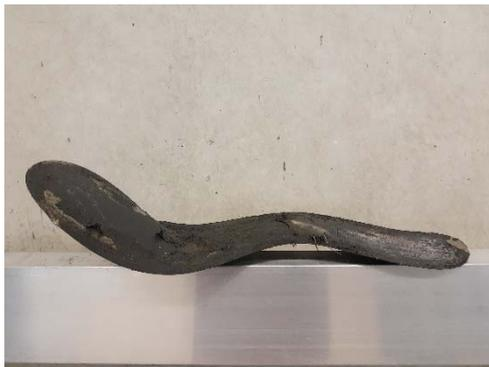
Abbildung 8: Induktiv erhitze und herausgelöste durchtrittsichere Sohle
