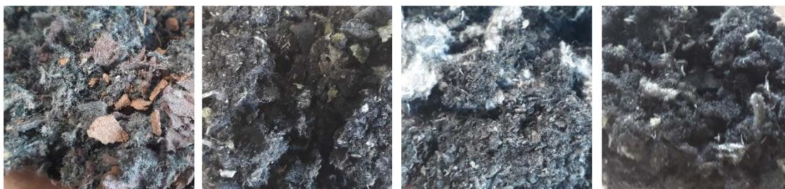
Abbildung 16: Zerkleinerte Schäfte für die Recyclingversuche bei der Rittec Umwelttechnik GmbH
