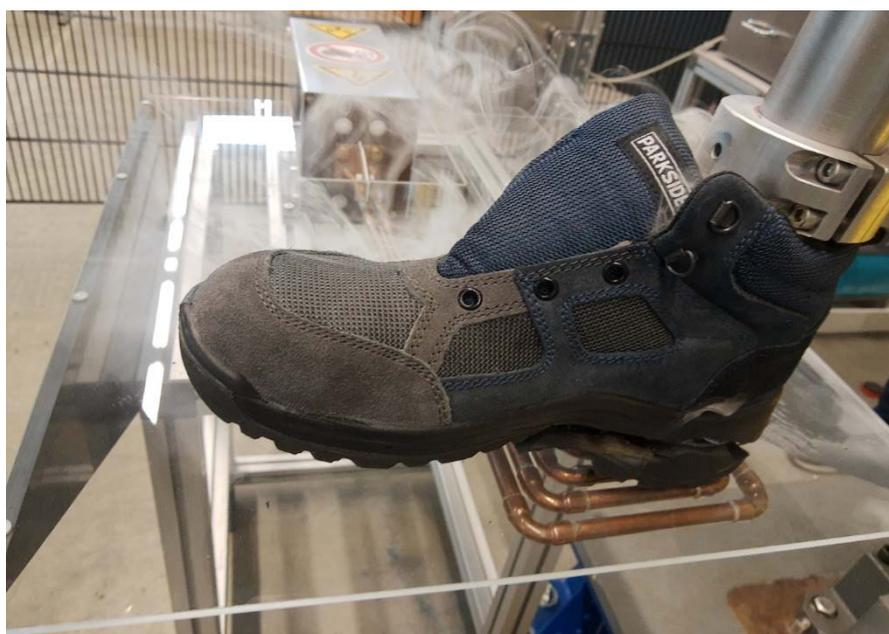
Abbildung 2: Induktionseinrichtung mit gekühlter Induktions-Spule und erhitzter Sohle
