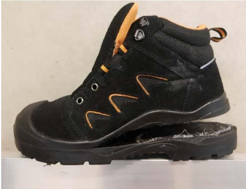
Abbildung 10: Im Fersenbereich aufgetrennte Laufsohle
